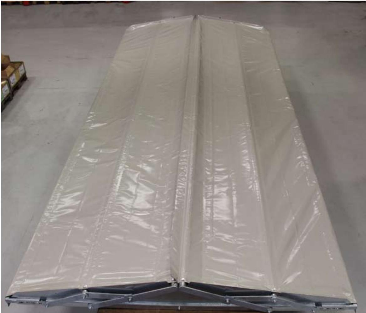
Fliptop Multi est maintenant prêt, le système doit être soulevé et installé sur le plateau.
