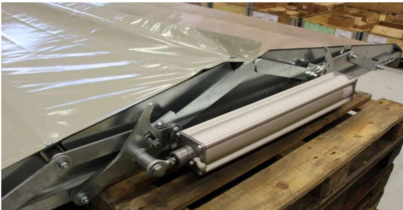
Maintenant les vérins hydraulique ou pneumatique peuvent être montés, ceci à l'aide des boulons prévus à cet effet.
