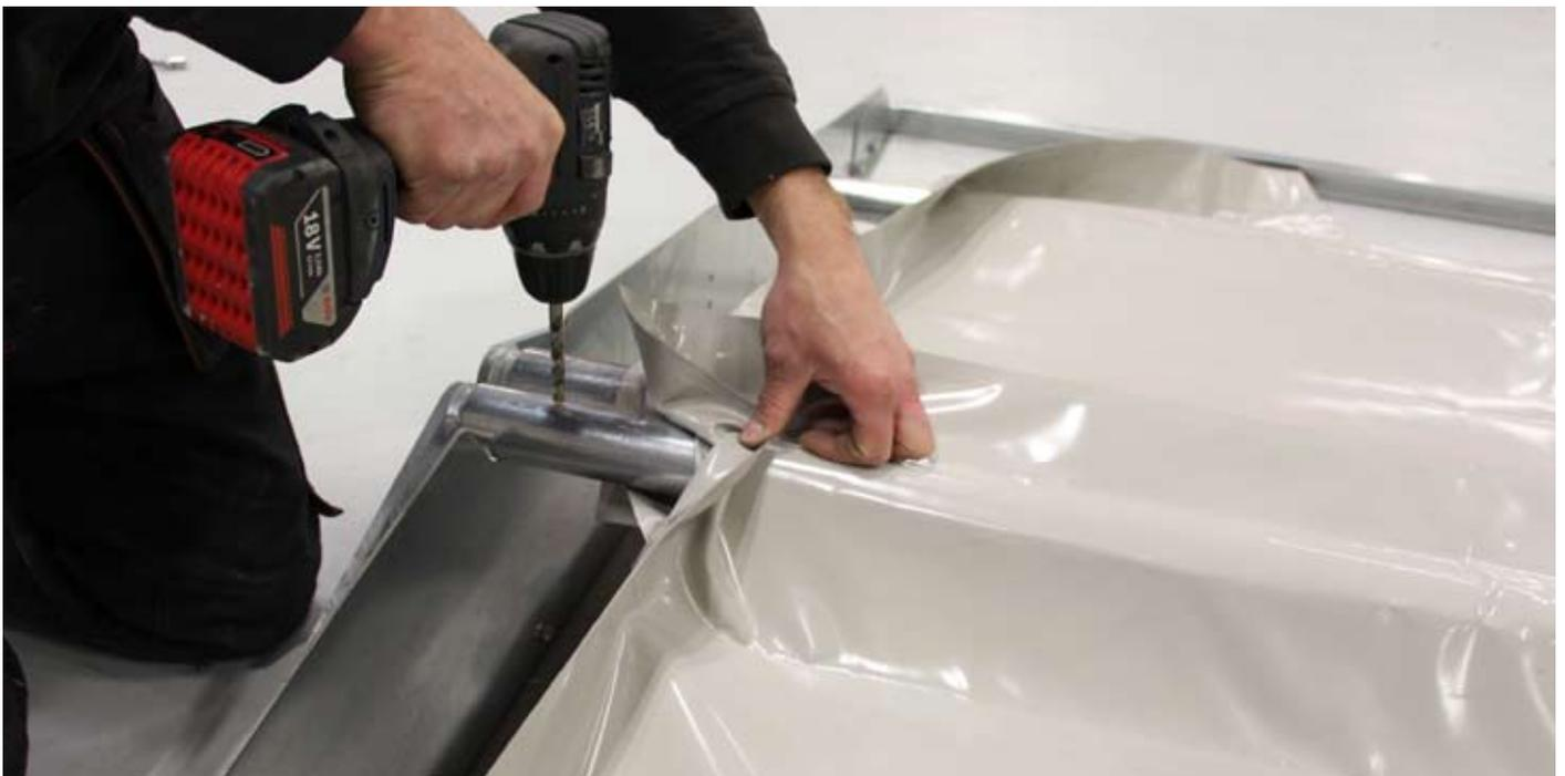
Chaque tubes (les quatre intérieurs 50x1,5 tubes ronds) doivent être percés d'après la photo.
