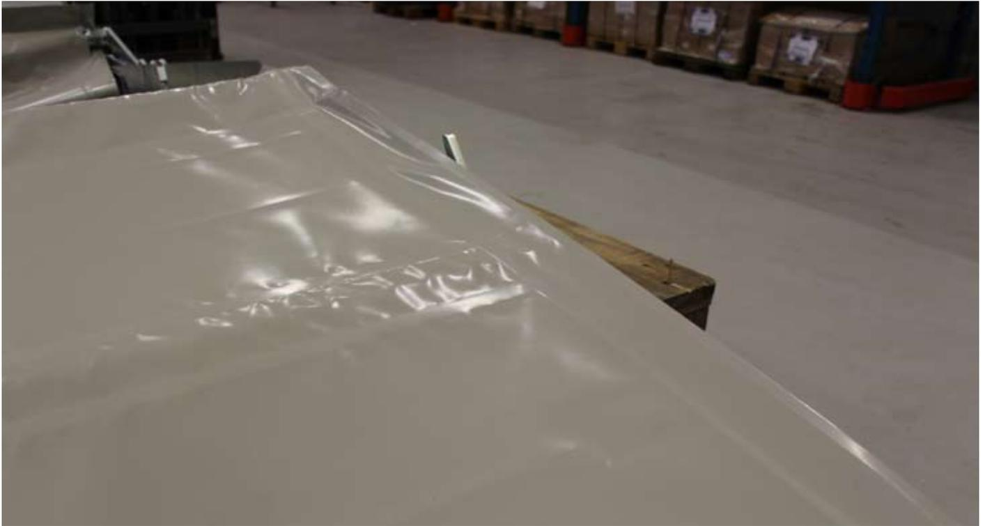
L'extrémité arrière doit couvrir le plat du montant.
