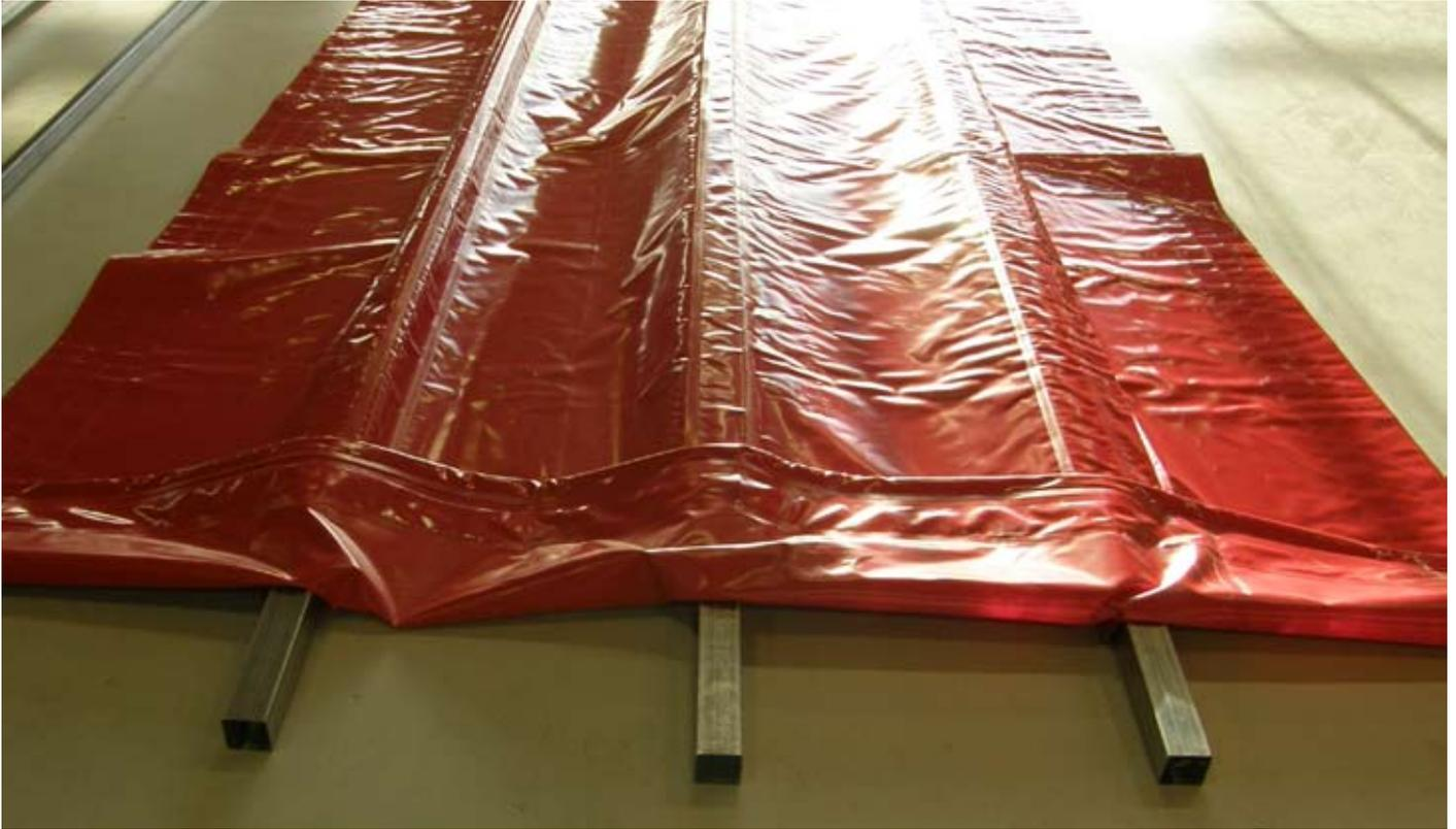
Legen Sie die Plane mit der Aussenseite nach oben aus und schieben Sie die 60x60x2 Rohre mit dem abgeklebten Ende voran (um die Plane nicht zu beschädigen) in die Kanäle.
