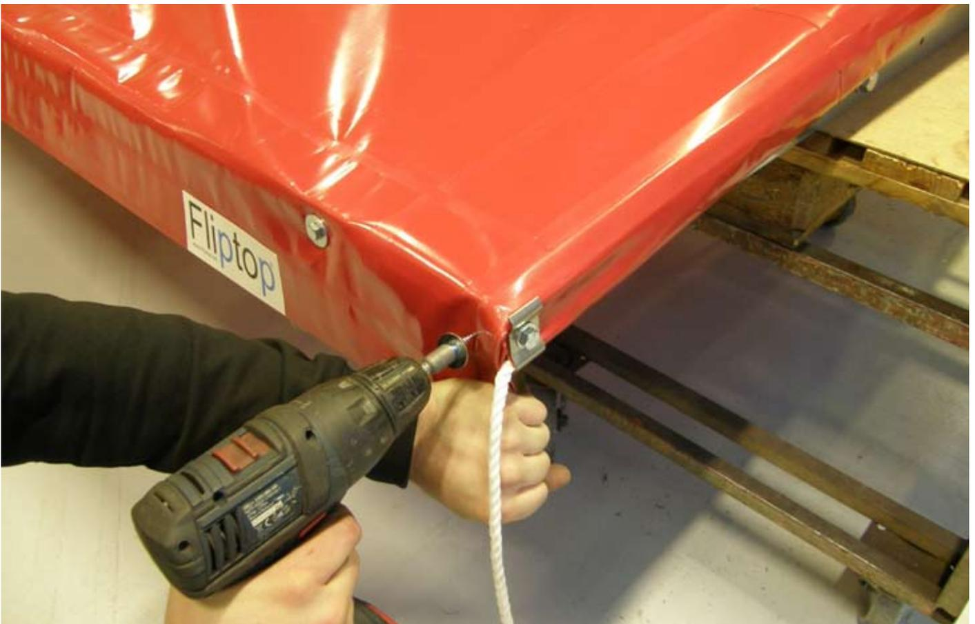
Schrauben Sie nun die Plane an den Längsseiten mit den Montageschrauben (5,5 x 20 + Unterlegscheibe) die der Plane beiliegen fest.
