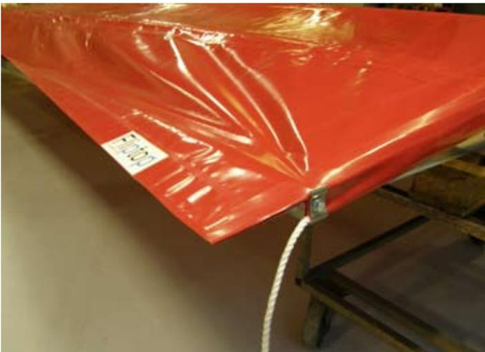
Bohren Sie ein Loch in die Plane und montieren Sie die Seilklammern an beiden Seiten der Giebel. Schneiden sie die Plane, wie auf dem Bild gezeigt, an beiden Giebeln ein. Verschraubung mittels M8x20 Schrauben.
