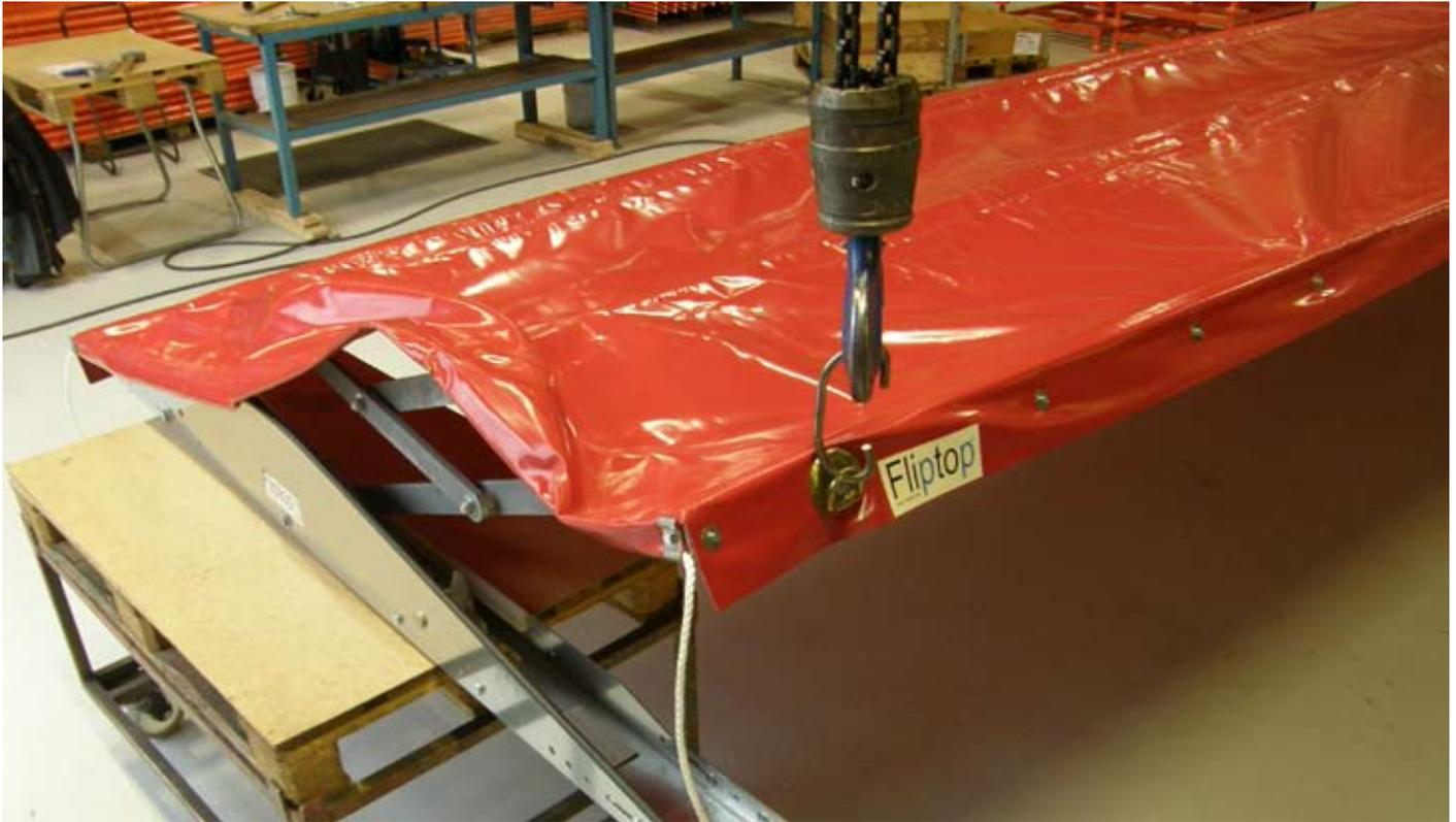
Das Seil wird am leichtesten gespannt, indem Sie das System um ca 100cm Öffnen.
