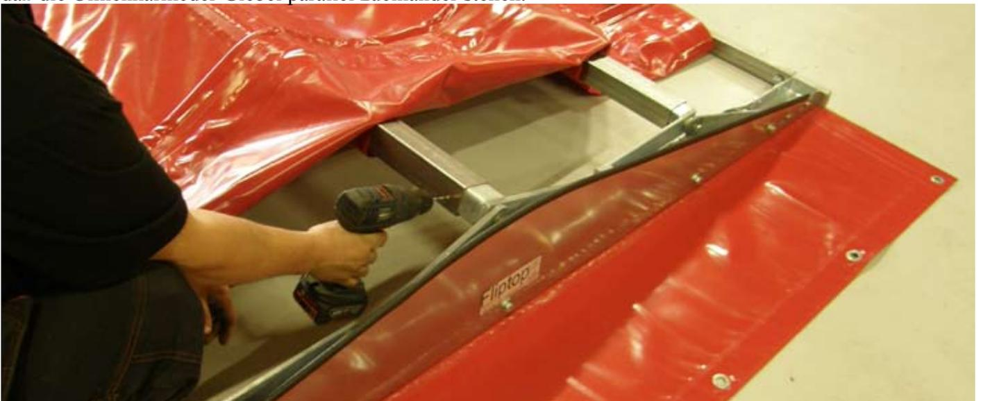
Jetzt wird jedes der mittleren Rohre (60x60x2) von der Seite mit einer M10x75, zwei Unterlegscheiben 11x28x2 und einer M10 Sicherungsmutterverschraubt. s.Bild
